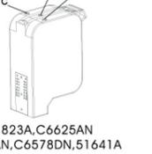
1. Legen Sie die Tintenpatrone auf ein Papiertuch oder ein anderes saugfähiges Material, um überschüssige Tinte aufzunehmen. Stellen Sie sicher, dass die Düsen nach unten zeigen.
