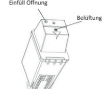
1. Legen Sie die Tintenpatrone auf ein Papiertuch oder ein anderes saugfähiges Material, um überschüssige Tinte aufzunehmen. Stellen Sie sicher, dass die Düsen nach unten zeigen.
